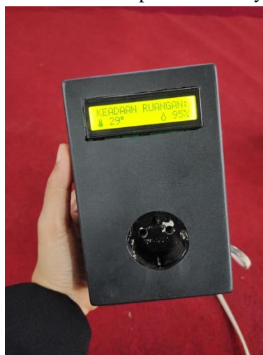
Gambar 4. Alat IoT yang digunakan untuk monitoring rumah jamur
